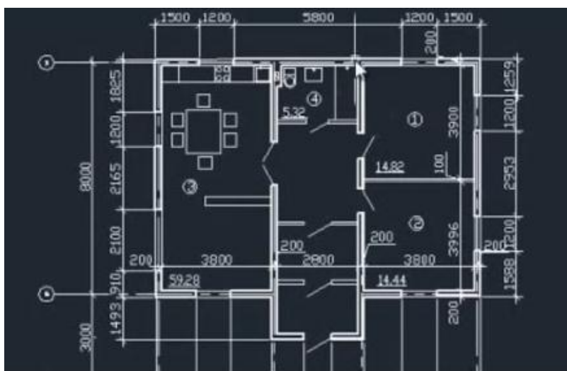
12-сурет. Ғимараттың негізгі элементтерінің сызбасын Autocad бағдарламасында орындау
