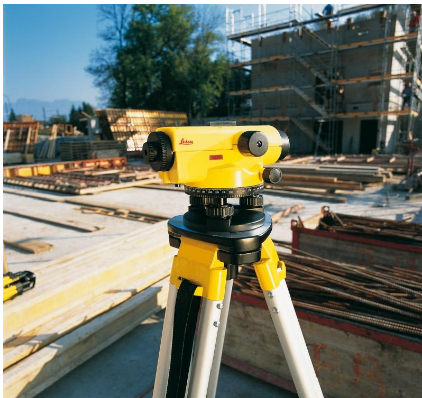
11-сурет. Leica RUNNER 24 оптика-механикалық нивелирі
